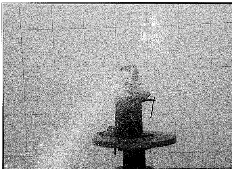
Figura 1 – Manômetro durante ensaio de jato d'água potente
