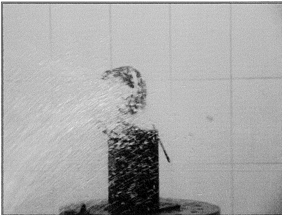
Figura 2 – Manômetro durante ensaio de jato d'água potente
