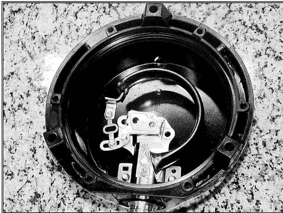
Figura 7 – Manômetro após ensaio em câmara de poeira (Ausência de poeira no interior)
