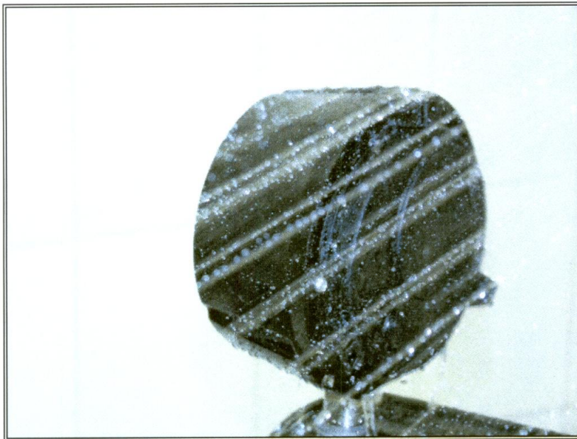
Figura 4 - Manômetro durante o ensaio de respingos de água em qualquer direção
