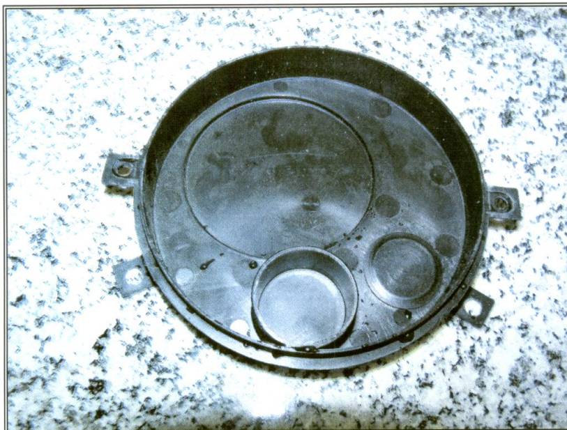
Figura 6 – Tampa traseira após ensaio de respingos de água
