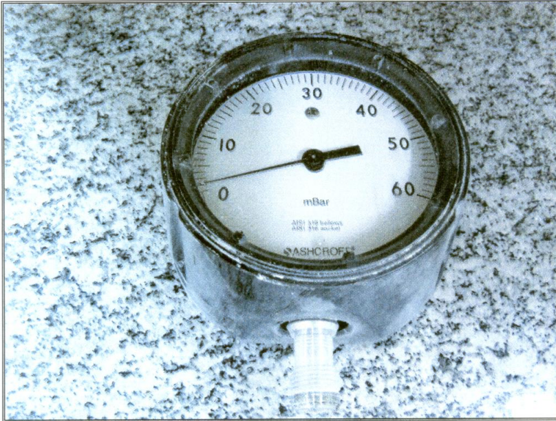
Figura 2 – Manômetro 1188 após exposição na câmara de poeira
