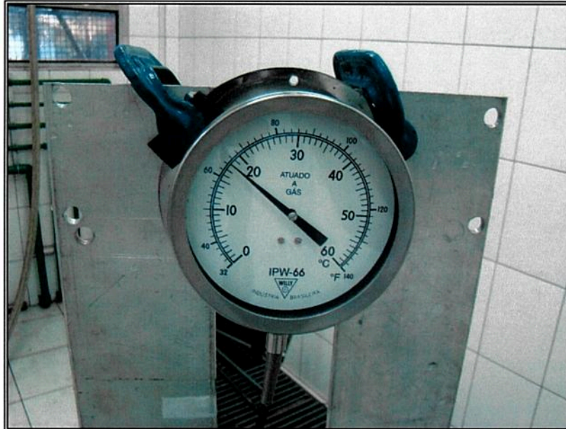
Figura 14 – Visor após exposição à jato d'água potente
