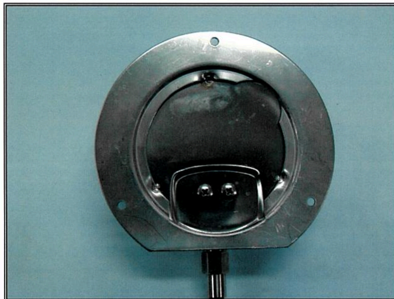
Figura 3 – Vista traseira da caixa do termômetro
