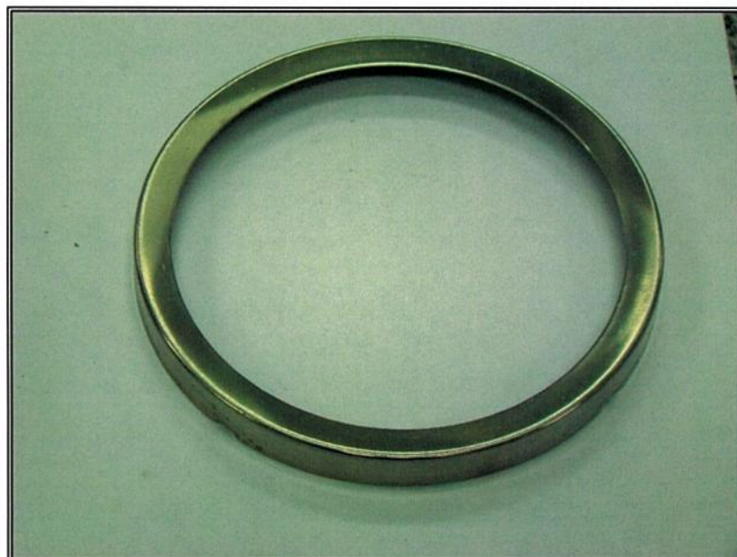
Figura 9 – Anel para fixação do visor e compressão da junta de vedação
