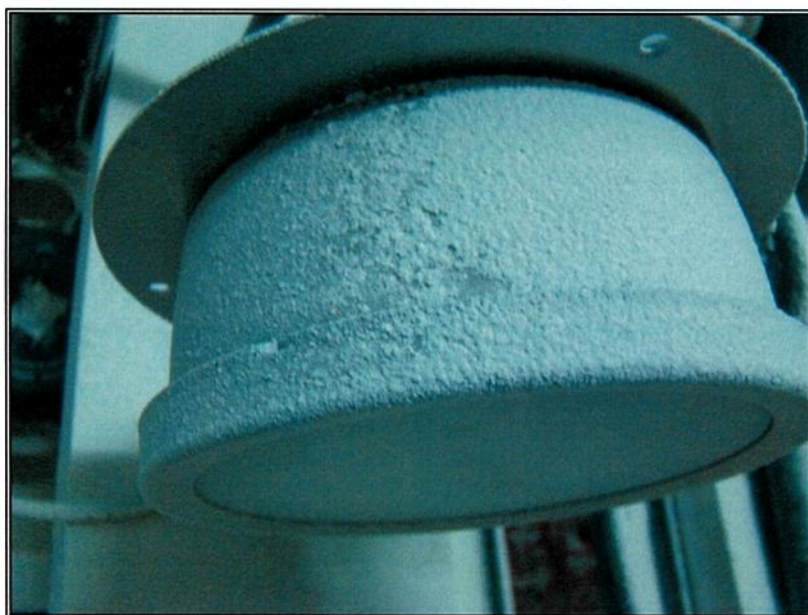
Figura 11 – Deposição de poeira na superfície externa da caixa do termômetro
